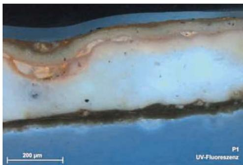
7 Querschliff durch die beiden Fassungen von Originalvergoldung (unten) und Überfassung (oben) im UV-Licht zur Visualisierung der Schichtabfolge.
